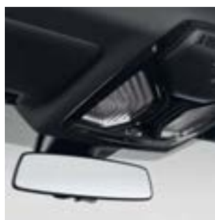
■ Der automatisch abdblendende Innenspiegel vermindert unangenehmes Blenden durch das Scheinwerferlicht nachfolgender Fahrzeuge.
